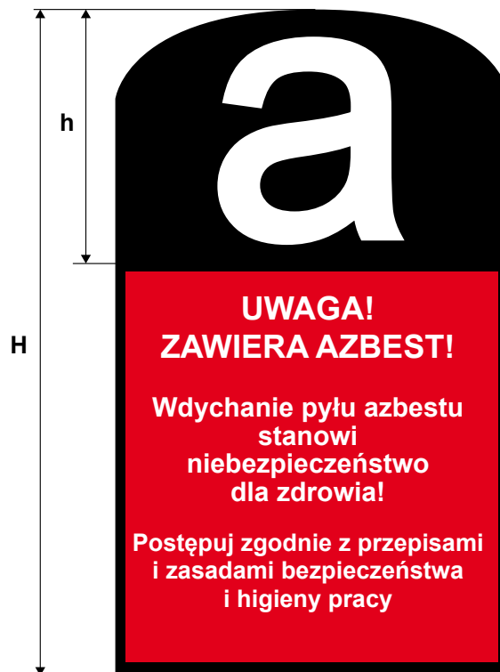
Rys. 6.6 Wzór oznakowania instalacji, urządzeń lub pomieszczeń zawierających azbest lub wyrobów zawierających azbest ( h = 40\% H ) [5]
