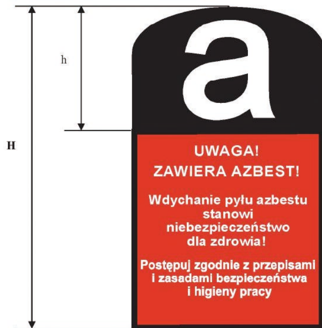
Fot VI.5 Wzór oznakowania instalacji lub urządzeń zawierających azbest oraz rur azbestowo-cementowych [6]
