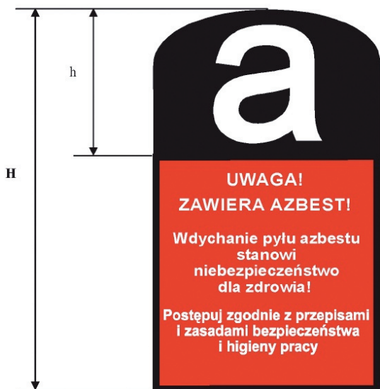
Rys. VI.6 Wzór oznakowania instalacji, urządzeń lub pomieszczeń zawierających azbest lub wyrobów zawierających azbest ( h = 40\% H ) [5]
