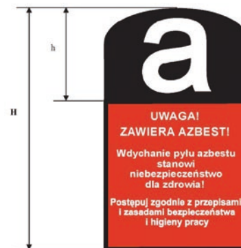
Fot. VI.2 Wzór oznakowania instalacji lub urządzeń zawierających azbest oraz rur azbestowo – cementowych [8] Jeżeli wyrób zawiera krokidolit, standardowo stosowany zwrot „zawiera azbest” powinien być zastąpiony zwrotem „zawiera krokidolit/azbest niebieski”
