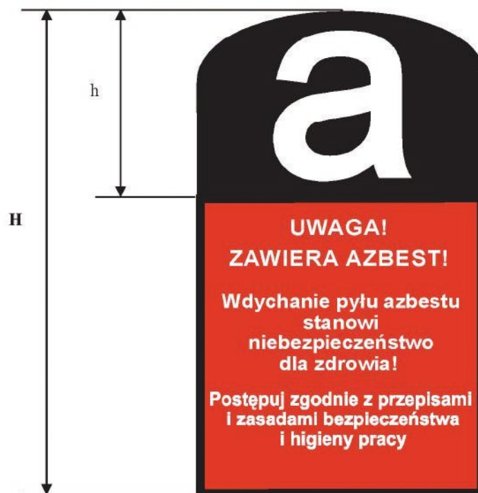
Fot. VI.3 Wzór oznakowania instalacji lub urządzeń zawierających azbest oraz rur azbestowo-cementowych [8]
