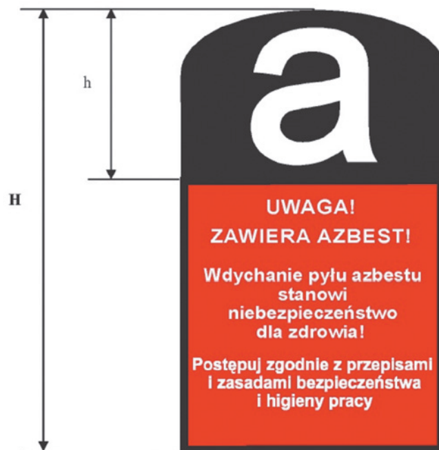
Rys. VI.1 Wzór oznakowania instalacji, urządzeń lub pomieszczeń zawierających azbest lub wyrobów zawierających azbest ( h=40\% H ) [6]
